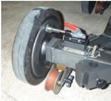
angezogene Radbremse an Basisdolly
