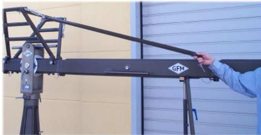
Abspannstange an Abstreitungshalterung am Kranmittelteil
