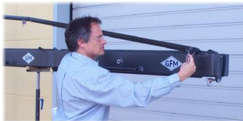
Einhängen der letzten Abspannungsstange
