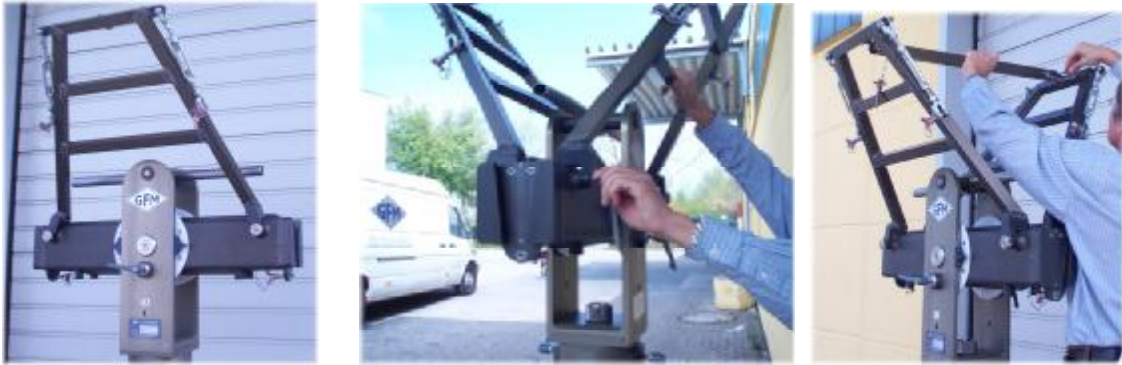
Anbringen der Abstrebungshalterung am Mittelteil
