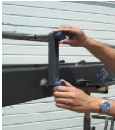
Montage der Parallelogrammstützen für Parallelogrammstange
