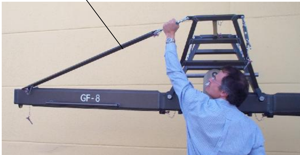
Abspannstange an Gegenausleger
