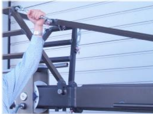
Spannen der Spannschlösser
